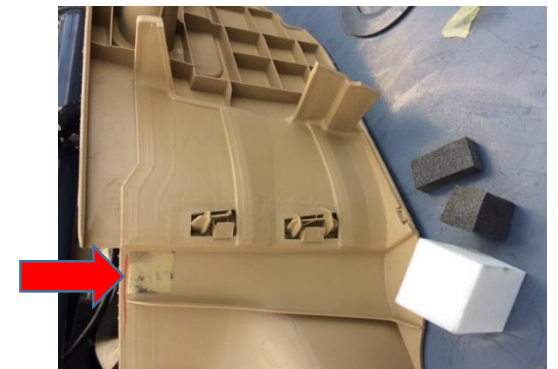
スポンジ等除去後の少量の残渣、糊跡はOK
