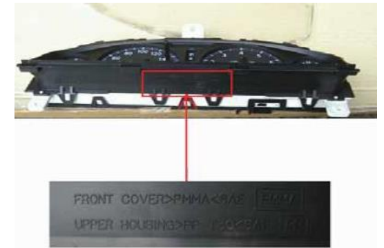
ボディ側に表記PMMA
