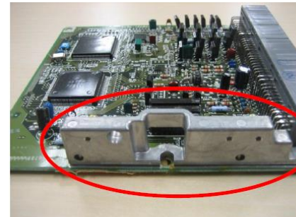
[例: アルミ板が付いている基板]
